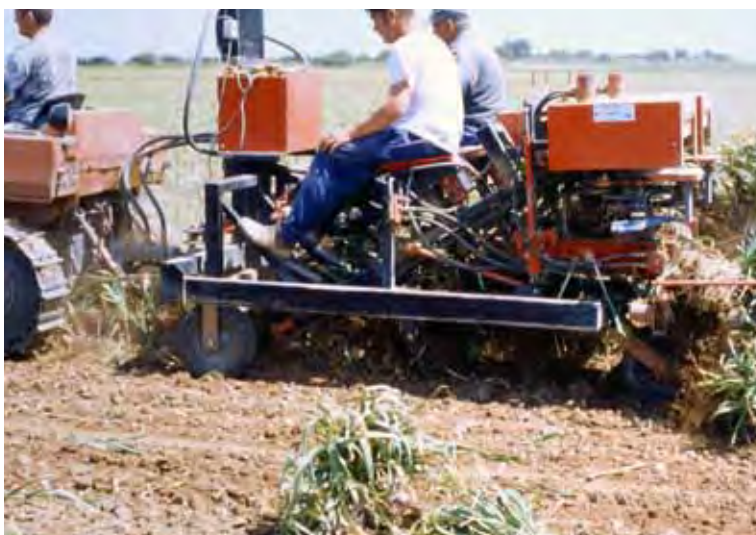
Figura 3. Recolectora gavilladora de ajos
